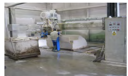
Imagen 4. Trabajo sin descargador de placas, ni medidas de protección ante el acceso
