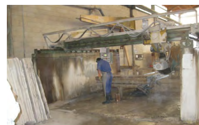
Imagen 8. Trabajo con disco puente, sin restricción de acceso
