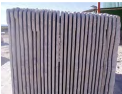
Imagen 1. Resultado de las operaciones en telar
