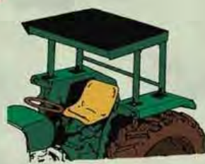
Pórtico de seguridad
