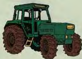
Cabina de seguridad
