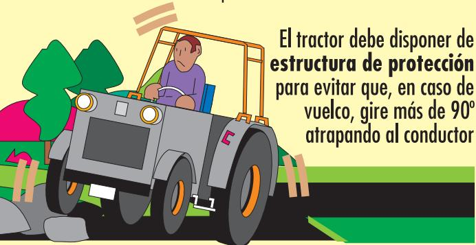
El tractor debe disponer de **estructura de protección** para evitar que, en caso de vuelco, gire más de 90º atrapando al conductor
