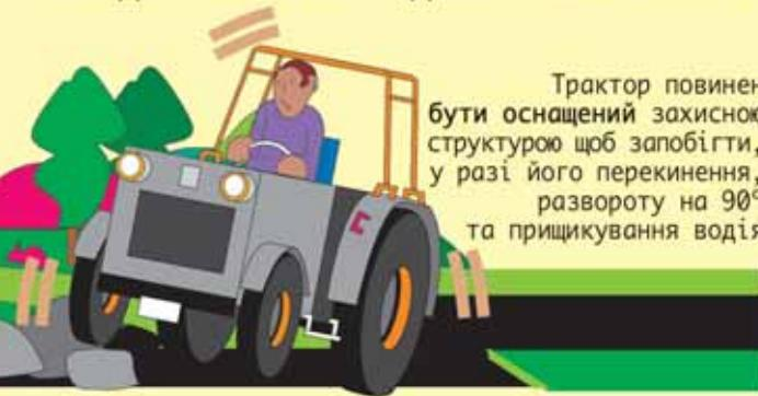
Трактор повинен бути оснащений захисною структурою щоб запобігти, у разі його перекинення, развороту на 90° та прищукування водія
