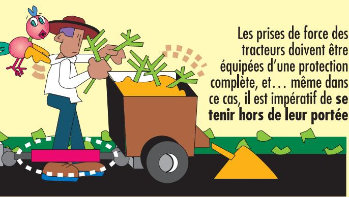
Les prises de force des tracteurs doivent être équipées d'une protection complète, et... même dans ce cas, il est impératif de se tenir hors de leur portée
