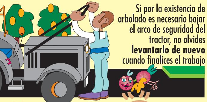
Si por la existencia de arbolado es necesario bajar el arco de seguridad del tractor, no olvides **levantarlo de nuevo** cuando finalices el trabajo
