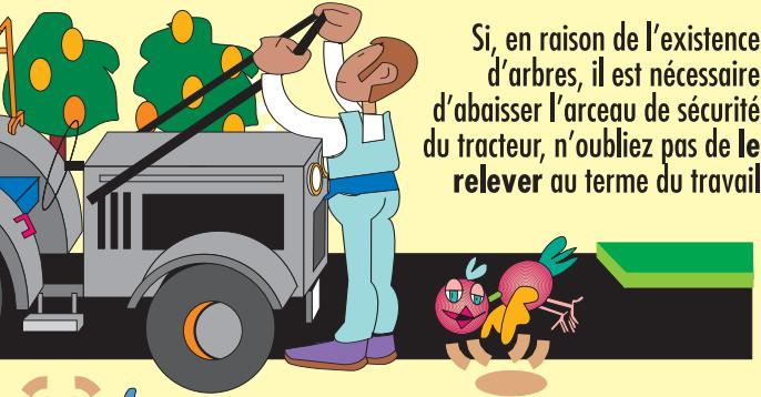
Si, en raison de l'existence d'arbres, il est nécessaire d'abaisser l'arceau de sécurité du tracteur, n'oubliez pas de le relever au terme du travail
