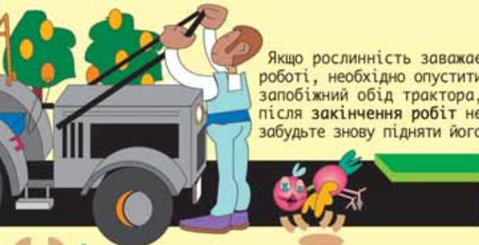
Якщо рослинність заважає роботі, необхідно опустити запобіжний обід трактора, після закінчення робіт не забудьте знову підняти його
