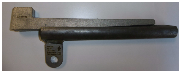
Anclaje para frente de cantera o bloques de piedra
