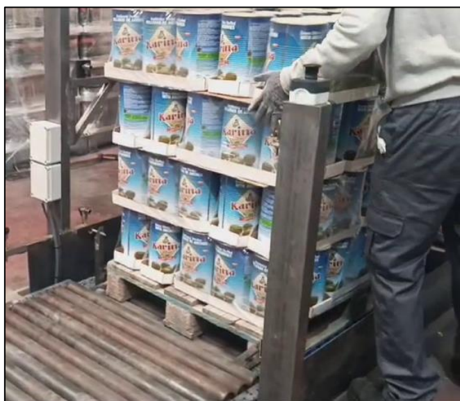
Palé y cargas sobre mesa elevadora instalada en foso
